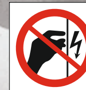
ЗАПРЕЩАЕТСЯ ПРИКАСАТЬСЯ. КОРПУС ПОД НАПРЯЖЕНИЕМ
